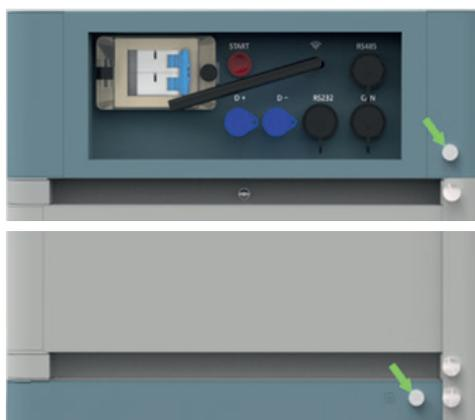
9. Sobald alle Batteriemodule und das BMS aufgebaut sind, können die Metallhalterungen an den beiden Ecken der Rückseite montiert werden
