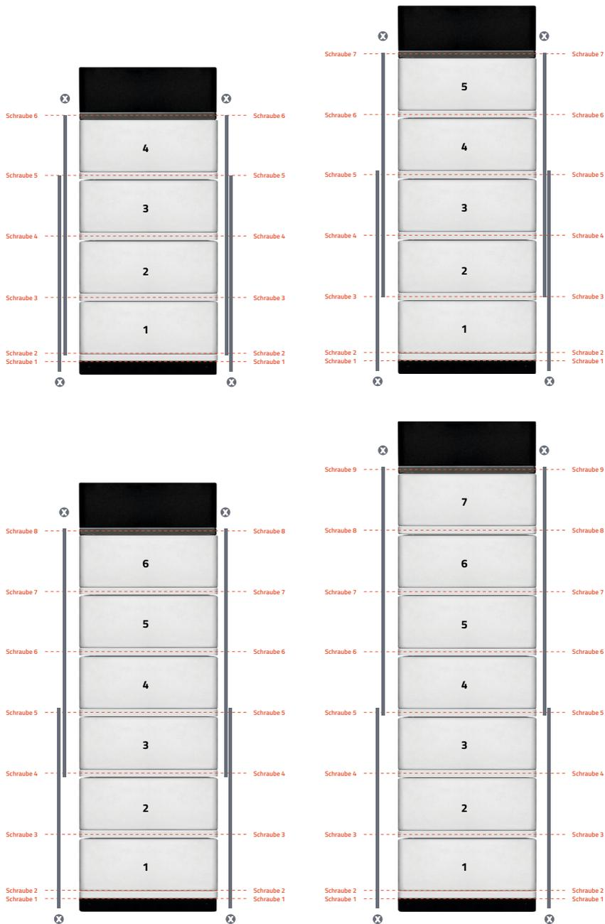
10. Befestige die seitlichen Metallbügel an der Vorder- und Rückseite des aufgebauten STAAK Eco Batteriespeichers mithilfe der M4 Fixierungsschrauben. Hierbei ist, je nach gewählter Aufbaugröße, eine unterschiedliche Montage der Metallbügel (X) auszuführen:
