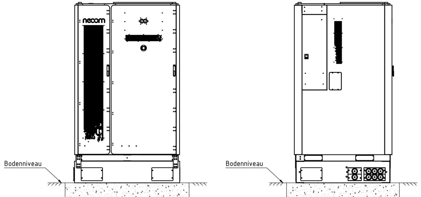
1. Die Stahlbasis muss auf einer Betonplatte montiert werden. Die Befestigung erfolgt mit 4x M16x120mm Schlaganker (im Lieferumfang enthalten) je Stahlbasis. Die empfohlene Bohrungstiefe beträgt 100mm.
